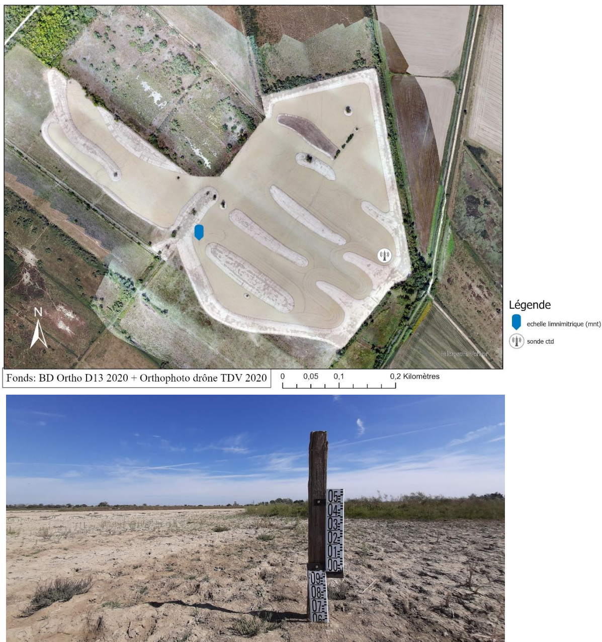
Figure 15 : a) Carte de localisation de la nouvelle échelle limnimétrique du marais b) Nouvelle échelle installée (P. Rocarpin, Tour du Valat, 2023)
