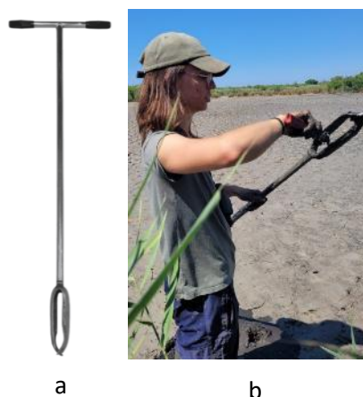
Figure 5 : Illustration de tarière pédologique. a) Tarière manuelle utilisée pour les sondages de 120 cm. b) Utilisation de la tarière manuelle sur le terrain
