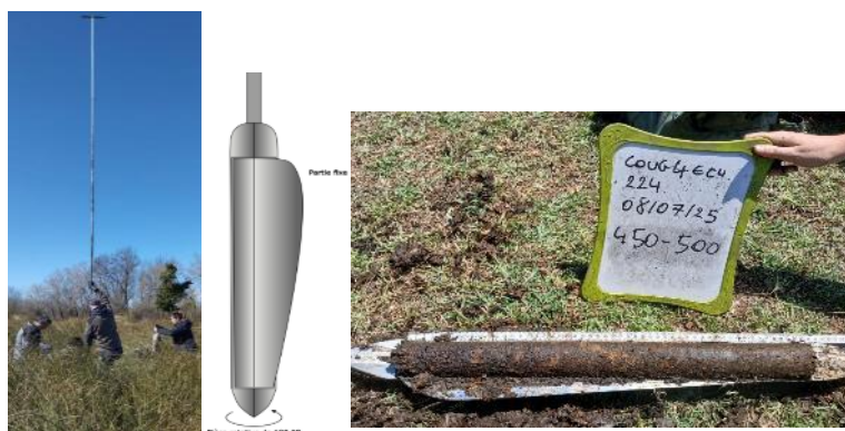
Figure 6 : Illustration du carottier russe. a) Prélèvement au carottier russe (© L. Saguet). b) Schéma de la gouge du carottier russe (© L. Saguet). c) Carotte de tourbe prélevée au carottier russe sur le site de Cougourlier (©V. Perret).
