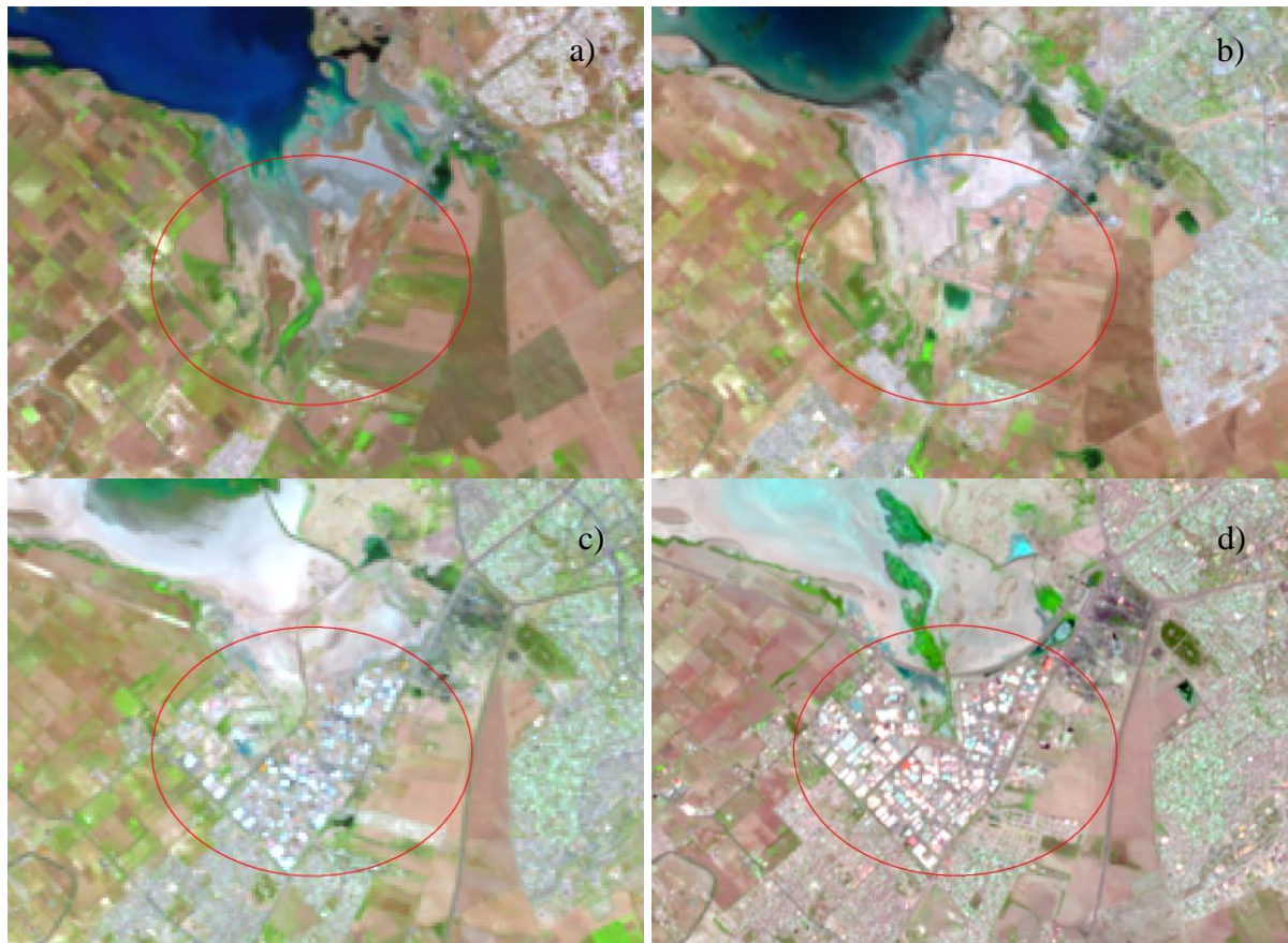
Figure 21 : Développement de la zone industrielle d'El Mghira (encerclée en rouge sur ces 4 images satellites) : a) 1987 : le site est encore quasi vierge de toute construction ; b) 2000 : les chantiers ont déjà débuté, tandis que les berges et les marais sont asséchés puis comblés ; c) 2010 : la plus grande partie de la zone industrielle est déjà construite et ; d) 2018 : situation actuelle, où près de 300 ha (essentiellement des habitats humides naturels, mais aussi quelques terrains agricoles) ont été transformés en zone industrielle.
