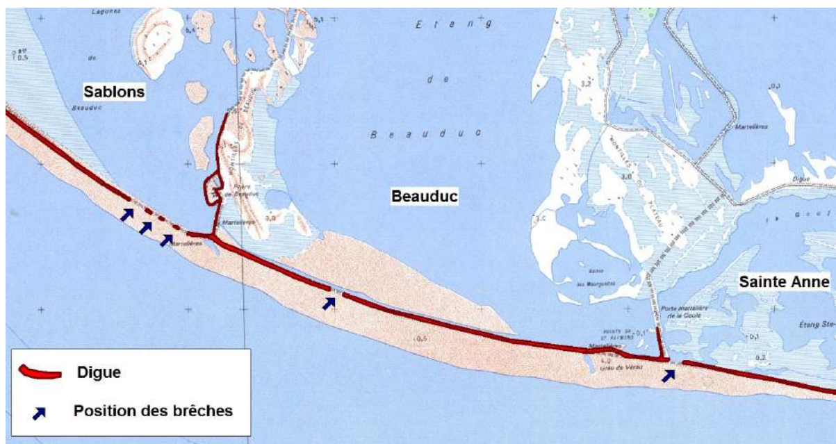
Carte 22 : Localisation des brèches sur les digues littorales, entre début 2010 et juillet 2011.
