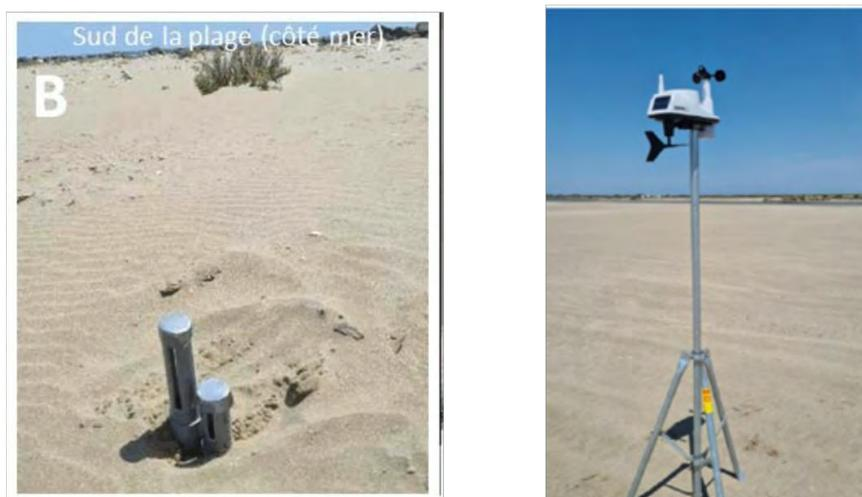
A gauche : pièges à sédiments utilisés pour mesurer le transport éolien, par piégeage dans les interstices des tubes A droite : station météorologique pour mesurer localement le vent
