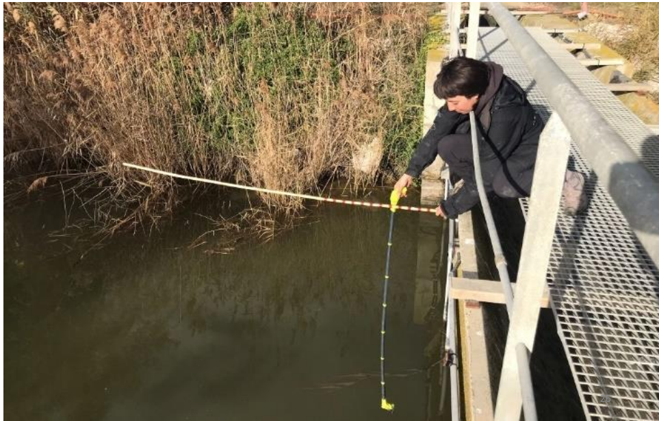
Figure A81 : Mesure de la portée de détection au niveau de la station aval du canal du Fumemorte.
