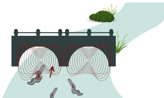
Figure 15 : Illustration d'un suivi en télémétrie RFID © C. Lefebvre
