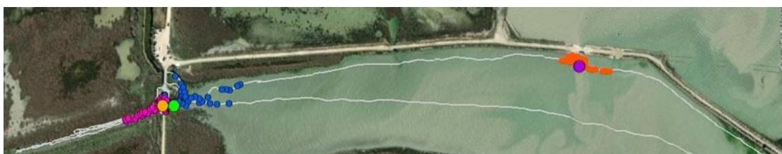
Figure A98. Exemple de transect réalisé en kayak à l'embouchure du canal du Fumemorte. Les gros points verts représentent les 3 hydrophones immergés. Les petits points turquoise correspondent aux détections du transpondeur-test (V13) par l'hydrophone "C", lorsqu'il était placé à 50cm en profondeur.
