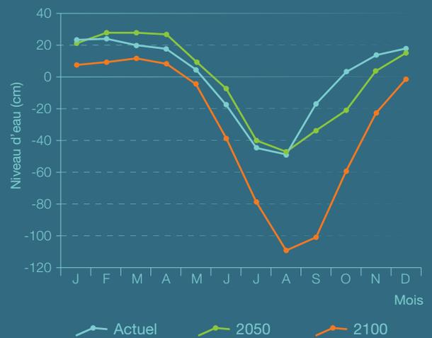
Fig. 1. Evolution de l'hydrologie d'un marais camarguais en fonction des précipitations actuelles et futures tel que simulé avec mar-o-sel
